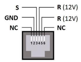
• Im nachfolgenden Bild finden Sie die Belegung des S88N Buchse (RJ45).
