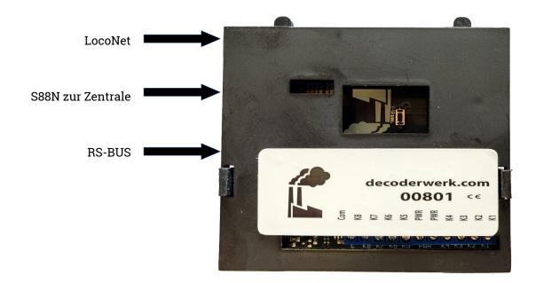
• Im nachfolgenden Bild finden Sie Belegung der RS-BUS Buchsen (RJ12).
