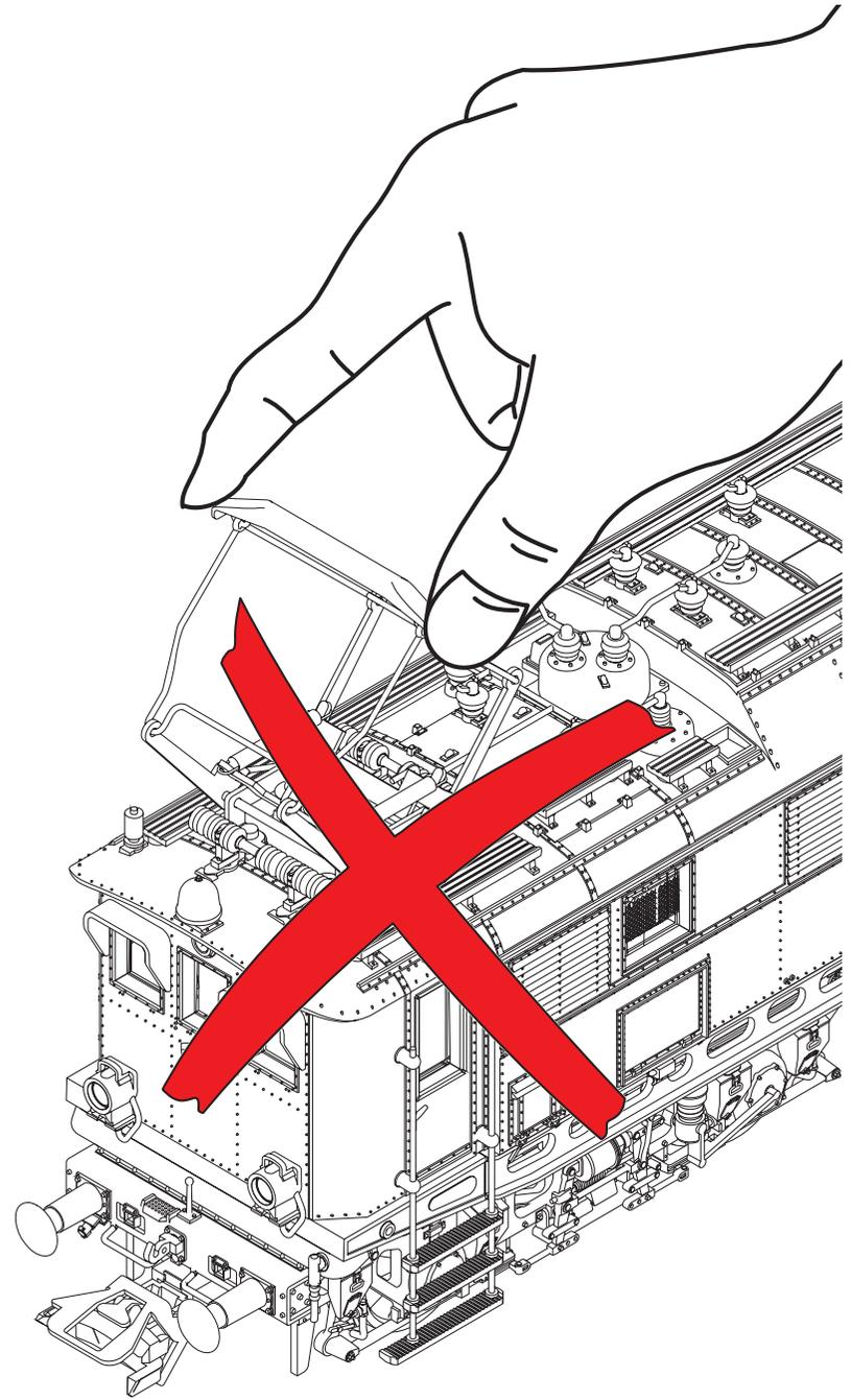
**Hinweis:** Vor dem ersten Betrieb der Lok müssen die Pantographen von Hand entriegelt werden. Der Pantograph federt selbst in die obere Stellung hoch.
