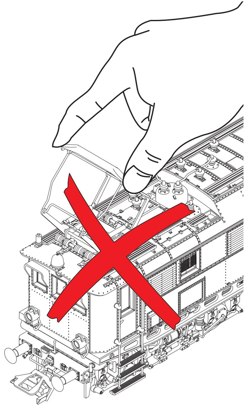
**Nota:** Antes de poner en servicio la locomotora por primera vez se deben desenclavar manualmente los pantógrafos. El pantógrafo sube automáticamente a la posición superior por actuación del sistema neumático.
