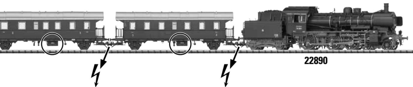
**⚡** = stromführende Kupplung; current-conducting couplers; Accouplements conducteurs; Spannung geleidende koppelingen;
