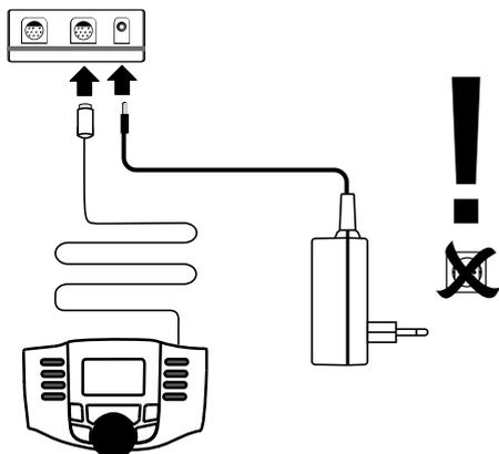
Når den mobile station og omformeren er tilsluttet den digitale tilslutningsboks, kan omformeren tilsluttes strømnettets stikdåse.
