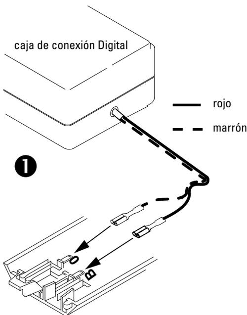
Después de haber conectado la caja de conexión Digital, las vías se ensamblan conforme al croquis inferior.
