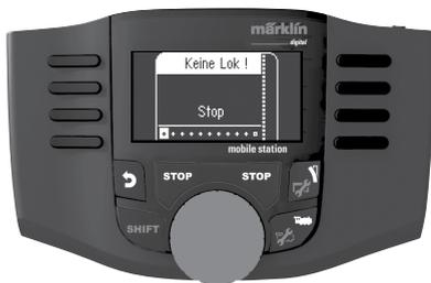
Ställ loket på spåret, tryck därefter på stoppknappen och vänta. Efter en liten stund syns den blinkande texten „mfx” på displayen. Detta visar att loket anslutits och att lokets data läses in.
