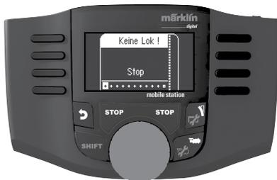
Stil lokomotivet på skinnerne, tryk derefter på knappen stop, for at frigive skinneanlægget. Efter kort tid vises mfx på displayet og blinker. Dermed vises, at lokomotivet er blevet genkendt og at dataene indlæses.
