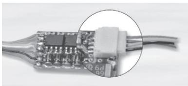
Das Soundmodul wird vom Decoder mit Spannung und Daten versorgt.
