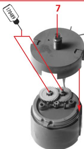
Gehäuse mit 2 Klammern verschließen.
