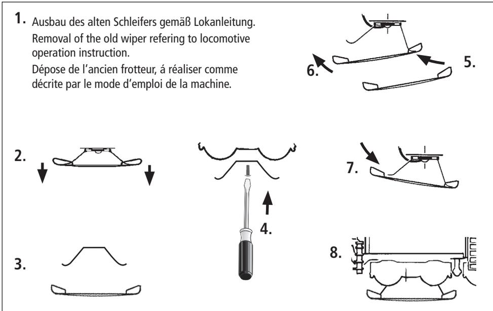
Zum Aus- und Einbau beachten Sie bitte auch die entsprechende Lokanleitung. Dieser Schischleifer passt an alle neueren ROCO-Lokomotiven. Bei der Umrüstung von älteren Lokomotiven und Fremdfabrikaten wenden Sie sich bitte an Ihren Fachhändler.
