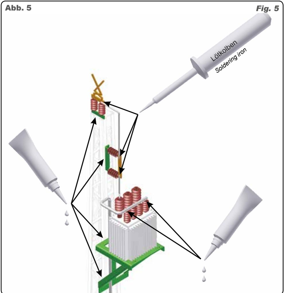
Der Oberleitungstrafo 4105 kann an folgende **Viessmann**-Masten montiert werden:
