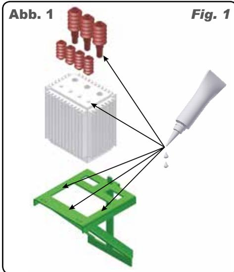
2. Nun verbinden Sie die Sicherung (Messingteil) und grünen Halter mittels der Isolatoren und etwas Klebstoff.
