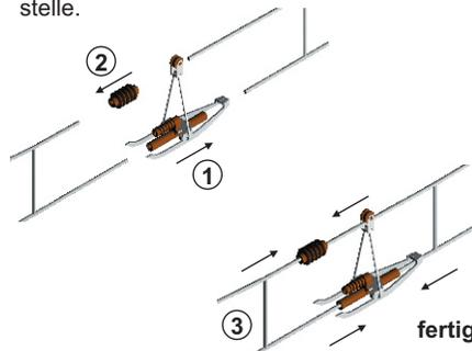
5. Bei stärkerer Zugbelastung des Fahrdrahtes können die Fügstellen mit etwas Sekundenkleber fixiert werden.
