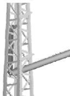
5. Drücken Sie den unteren rechten Schenkel von hinten mit der Spitze eines Schraubendrehers oder eines Kugelschreibers an das Winkelblech heran.
