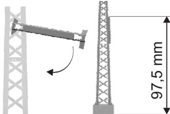
3. Führen Sie die oberen beiden Schenkel wie dargestellt hinter die Winkelbleche des Mastes. Achten Sie dabei darauf, dass Sie die Universal-Halterung in der richtigen Höhe anbringen.
