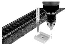
11. Markieren Sie mit Hilfe eines Stiftes die Schraubenspositionen. Anschließend entfernen Sie den Grundträger und bohren mit einem ca.  $\text{R } 1 \text{ mm}$  Bohrer die ermittelte Position vor.
