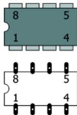
ICs erfüllen je nach Typ verschiedene Aufgaben. Die verbreitetste Gehäuseform ist das sogenannte "DIL"-Gehäuse, aus dem seitlich 4, 6, 8, 14, 16, 18 oder mehr "Beinchen" (Pins) herausragen.
