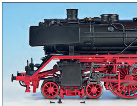
Links: Die Front der Lok ist bereits mit allen Pufferträgerdetails bestückt. Für die Zylinder liegen im Zurüstbeutel Entwässerungshähne, Kolbenstangenschutzrohre und Zylindersicherheitsventile zur Selbstmontage bei. Zur Montage der letzten beiden Teile müssen zunächst winzige Käppchen entfernt werden (unten).
