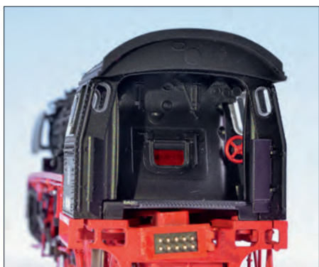
Im Stehkessel ist die Lokplatte untergebracht. Sie trägt die Schnittstelle für den Digitaldecoder, der gegen den Blindstecker getauscht werden kann.
