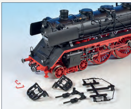
Links: Die Front der Lok ist bereits mit allen Pufferträgerdetails bestückt. Für die Zylinder liegen im Zurüstbeutel Entwässerungshähne, Kolbenstangenschutzrohre und Zylindersicherheitsventile zur Selbstmontage bei. Zur Montage der letzten beiden Teile müssen zunächst winzige Käppchen entfernt werden (unten).
