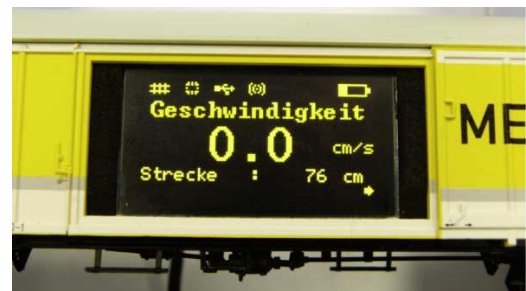
Geschwindigkeitsanzeige in cm/s
