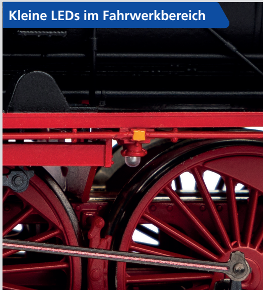
Zahlreiche freistehende Leitungen
