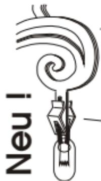
Durch neuartige Sandwichbauweise kein störendes Kabel im oberen Bereich der Leuchte !
