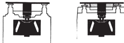
Vorhandene Kupplung zusammen mit der Kupplungsbefestigung (Kupplungskammer oder ähnliches) entfernen.
