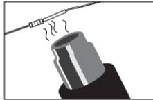
9. Kurz (!) erhitzen, etwa mit einer Heißluftpistole. Schon ist die dauerhafte Verbindung fertig! Vorsicht Verbrennungsgefahr!
