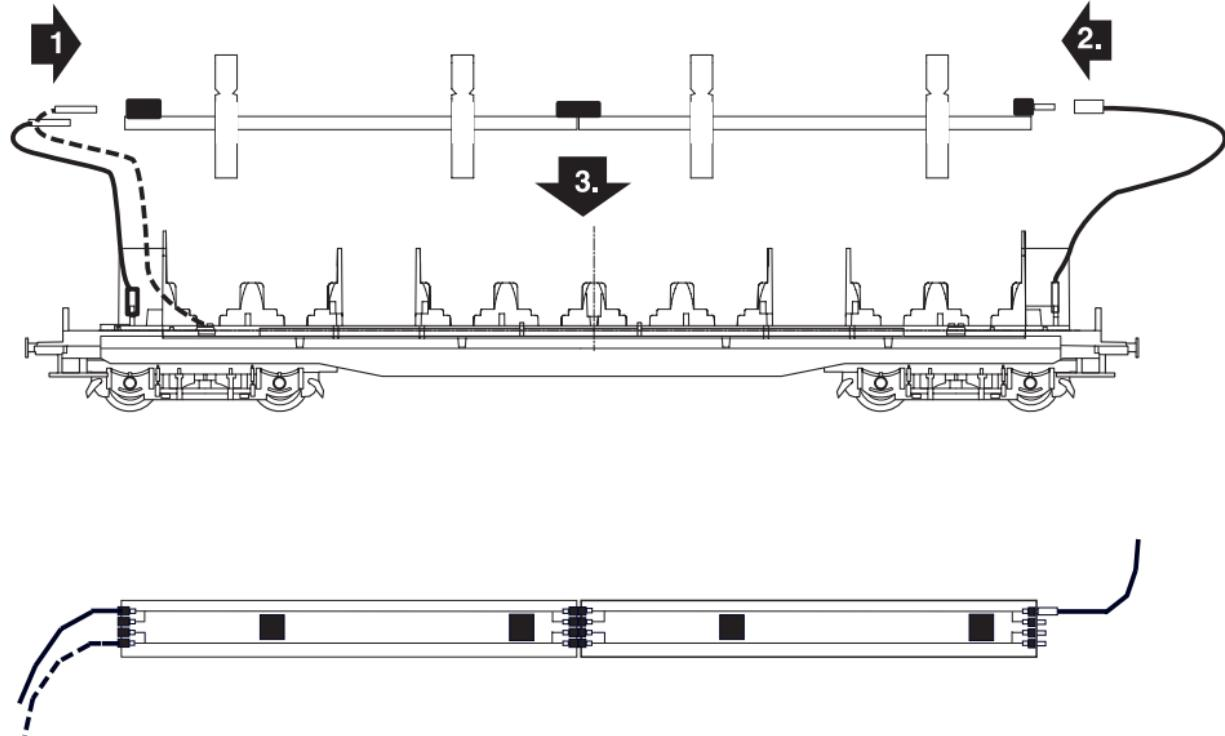
Anschluss der Innenbeleuchtung 73400 an Wagen mit Schleifer.
