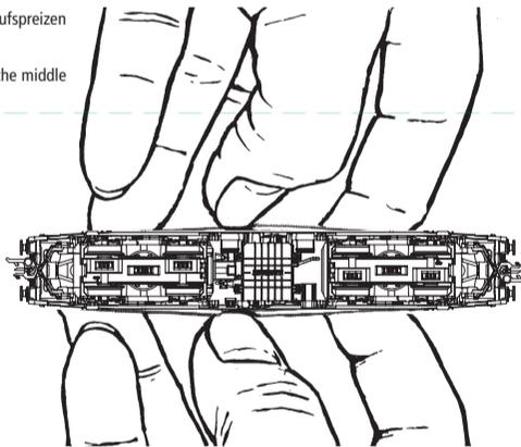
**2.** Halteklammern aufbiegen. Platine und Motor ausbauen.
