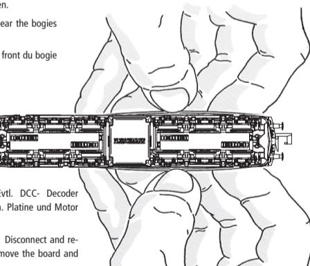
2. 3 Schrauben lösen. Evtl. DCC-Decoder ausstecken und ablösen. Platine und Motor ausbauen.
