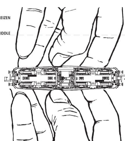
2. HALTEKLAMMERN AUFBIEGEN. PLATINE UND MOTOR AUSBauen.
