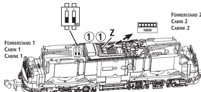
Hinweis: Die Stirnbeleuchtung der Lok kann mit Hilfe der DIP-Schalter S1 (für FS2) oder S2 (für FS1) auf der Platine für jede Lokseite abgeschaltet werden.
