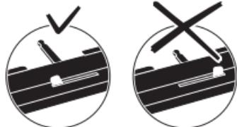
Al colocar el motor 75491 se debe observar la posición correspondiente de la palanca (véase ilustración).
