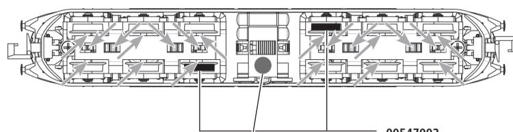
An den markierten Stellen kann der Schaltmagnet 942701 eingebaut werden.
