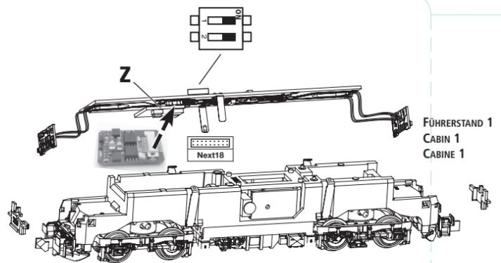
**Hinweis:** Die Stirnbeleuchtung der Lok kann mit Hilfe der DIP-Schalter S1 (für FS2) oder S2 (für FS1) auf der Platine für jede Lokseite abgeschaltet werden.
