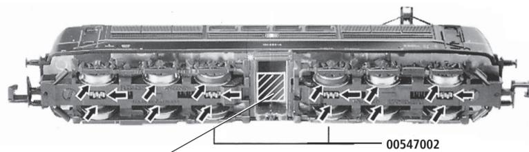
An der markierten Stelle kann der Schaltmagnet 942601 / 942701 eingebaut werden.
