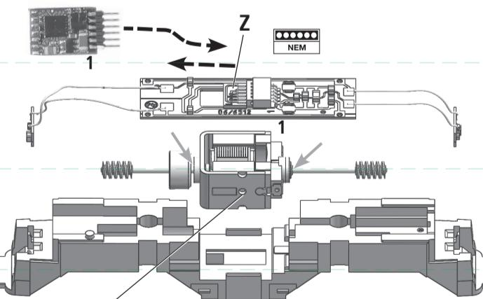
Einbau eines digitalen Empfängerbausteins:
