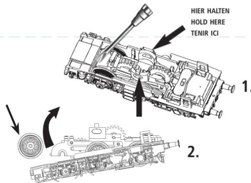
**Reinigen der Lokräder:** Bei Verschmutzung sind die Laufflächen der Räder mit sauberem Lappen oder Schienenreinigungsgummi 6595 zu reinigen. Niemals die angetriebenen Räder von Hand durchdrehen, sondern durch Anlegen einer Fahrspannung mittels Anschlussdrähten antreiben. Nichtangetriebene Räder können von Hand gedreht werden.
