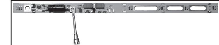
Mit einem geeigneten Schraubendreher kann die gewünschte Helligkeit am Potentiometer eingestellt werden.
