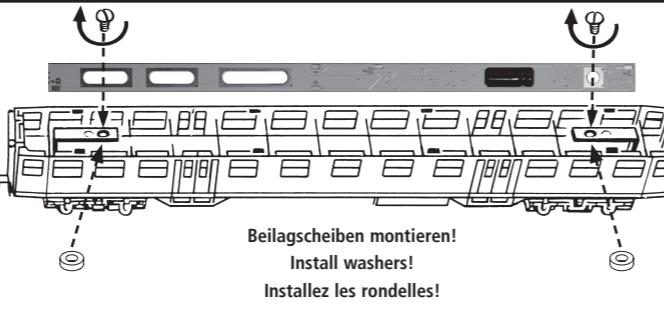
Bei der direkten Beleuchtung wird die Leiterplatte so befestigt, dass die LED's nach unten ins Wageninnere zeigen. Die mitgelieferten Beilagscheiben müssen unbedingt zwischen Leiterplatte und Metallbügel angebracht werden, ansonsten werden die elektronischen Bauelemente auf der Leiterplatte zerstört!
