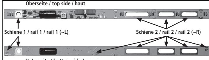
Wenn die Leiterplatte nicht über die Schraubkontakte angeschlossen werden kann, besteht auch die Möglichkeit sie mit Litzen an den Lötpunkten anzuschliessen.
