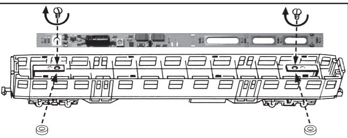
Bei der indirekten Beleuchtung wird die Leiterplatte so befestigt, dass die LED's nach oben zum Dach zeigen. In das Dach wird einer der beiliegenden Reflektorstreifen geklebt. Die Alufoilie ergibt eine kühle Farbtemperatur (Leuchstofflampen), die Kupferfolie ergibt eine warme Farbtemperatur (Gaslampe / Glühlampe). Die Einbauhöhe der Leiterplatte kann durch Unterlegen der Beilagscheiben variiert werden.
