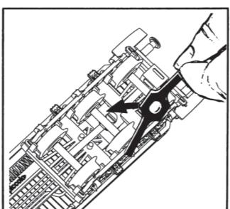
Zum Einsetzen der Stromabnehmerfeder die Schraube **nicht** lösen; nur über den Schraubenkopf legen. Je nach Achsabstand die kurze oder die lange Kontaktfeder verwenden.
