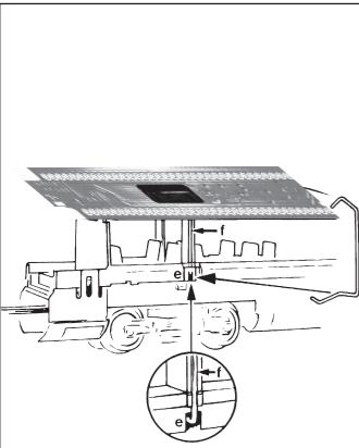
Den Kontaktbügel unten lose einführen, oben über die Kante der Leiterplatte einhängen und abschließend am Punkt **e** fest einrasten. Der Kontaktbügel muss im Schlitz **f** liegen. Insgesamt müssen 4 Kontaktbügel montiert werden.
