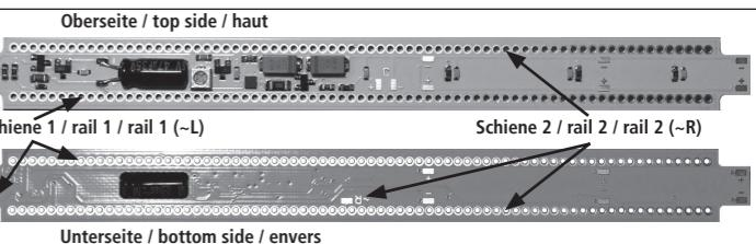
Wenn die Leiterplatte nicht über die Kontaktbügel angeschlossen werden kann, besteht auch die Möglichkeit sie mit Litzen an den Lötpunkten anzuschliessen.
