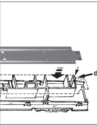
Leiterplatte so auf die Inneneinrichtung legen, dass der Zapfen **d** der Inneneinrichtung in der entsprechenden Ecke der Leiterplatte liegt. Die LED's zeigen nach unten ins Wageninnere. Mit einem Streifen Klebeband am Wagenboden provisorisch fixieren.
