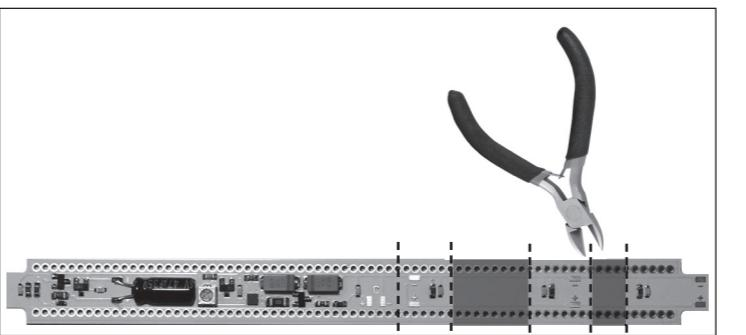
Wird die Leiterplatte in kürzere Wagen eingebaut, muss sie an den vorgesehenen Stellen gekürzt werden. Mit einem Seitenschneider oder einer Schere schneidet man die Leiterplatte auf die benötigte Länge. Der Einbau erfolgt auf die im Folgenden beschriebene Weise.
