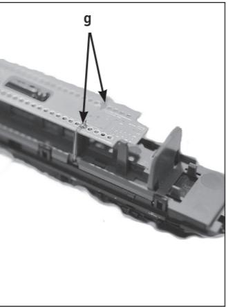
Es wird empfohlen, die Kontaktbügel auf der Leiterplatte zu verlöten **g**, um eine sichere und unterbrechungs-freie Kontaktierung zu gewährleisten.
