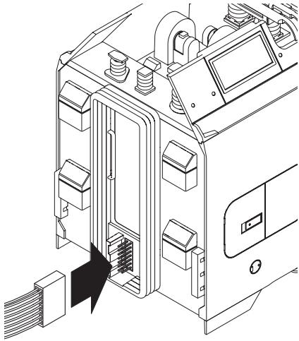
Bild 1, Verbindungskabel einstecken
