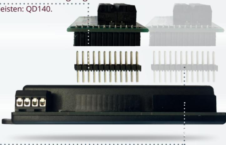
Der **ZA3-Switch-16** kann auch auf dem rechten Steckplatz des **ZA3** eingesetzt werden.
